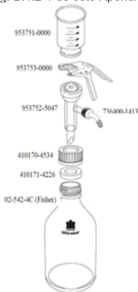
Fig. B.1.2-1 Partes del dispositivo de filtración
